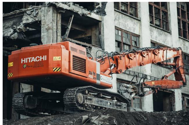
Рис. 3 - Экскаватор-разрушитель Hitachi ZX480 LCK
