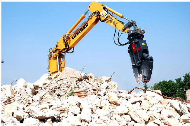
Рис. 2 - Гидроразрывники экскаватора-разрушителя «Либхерр»
