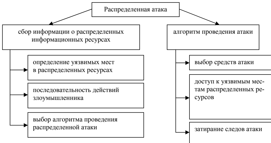
Рис. 1. Этапы проведения распределенной атаки на распределенные информационные ресурсы соответствующего подразделения консалтингового предприятия
